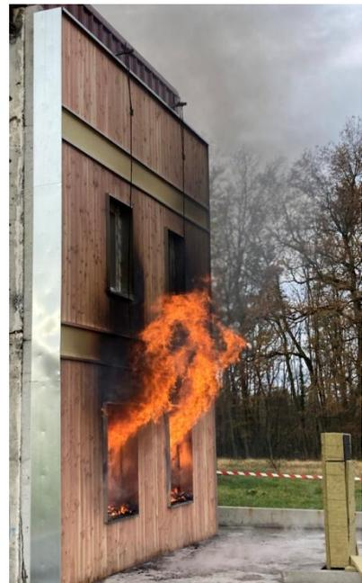
Après une recherche des facteurs influençants par des essais petite échelle, de la modélisation numérique et un premier essai LEPIR 2 d’orientation réalisé en février 2020, le “Groupe Feu” a obtenu, en décembre dernier, un essai LEPIR 2 qualifiant sur la conception de façade.
